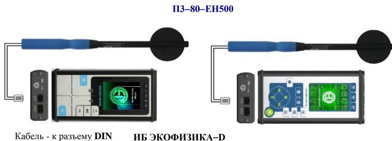
Рис.1. Подключение ПЗ-80-ЕН500 к ИБ ЭКОФИЗИКА-Д
