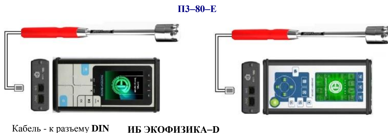
Рис.2. Подключение ПЗ-80-Е к ИБ ЭКОФИЗИКА-Д
